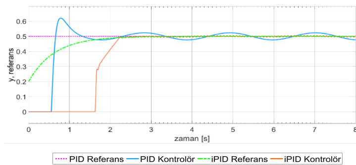
Şekil 9. Manyetik Levitasyon modeli güç amplifikatörü üzerinde bulunan elektromanyetik bobin endüktans değerinde kurgulanan değişiklikler sonrası PID ve iPID-α kontrolör yapılarının referans ve çıkış değerleri
