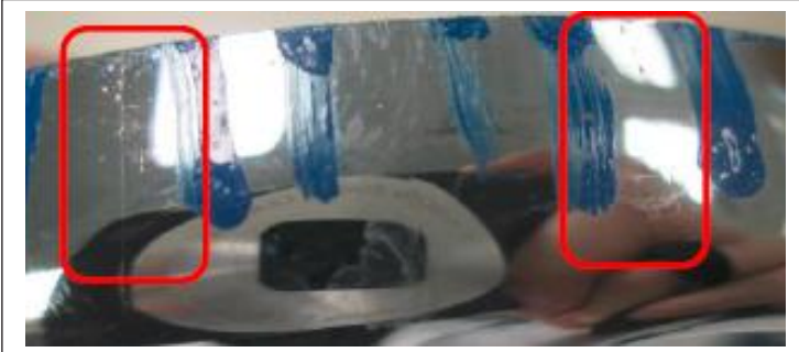
Şekil 2. Krom Kaplanmış Yüzeyde Test Sonrası Gözlenen Çatlaklar
