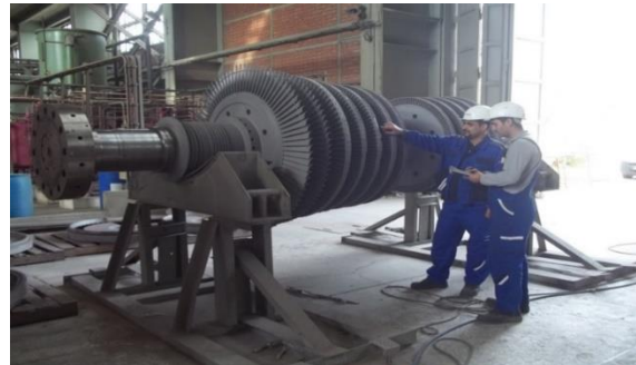
Şekil 4. Rotorun desteklere montajı.
