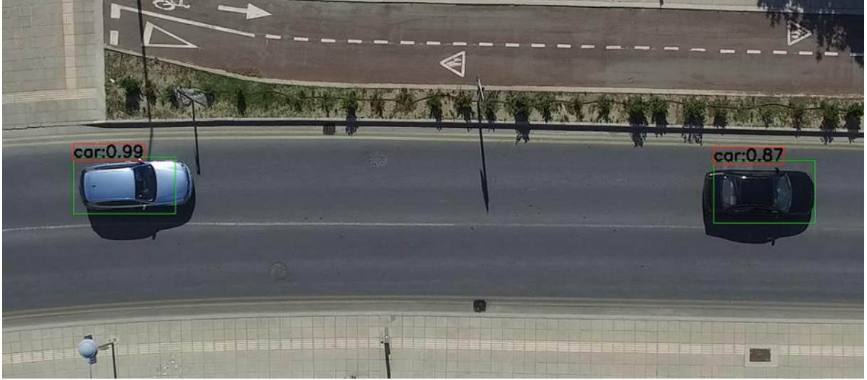
Şekil 4.3- 50m yükseklikten çekilmiş drone görüntüsü üzerinden Faster R-CNN Beslemeli YOLO algoritmasının araç tespit başarısı
