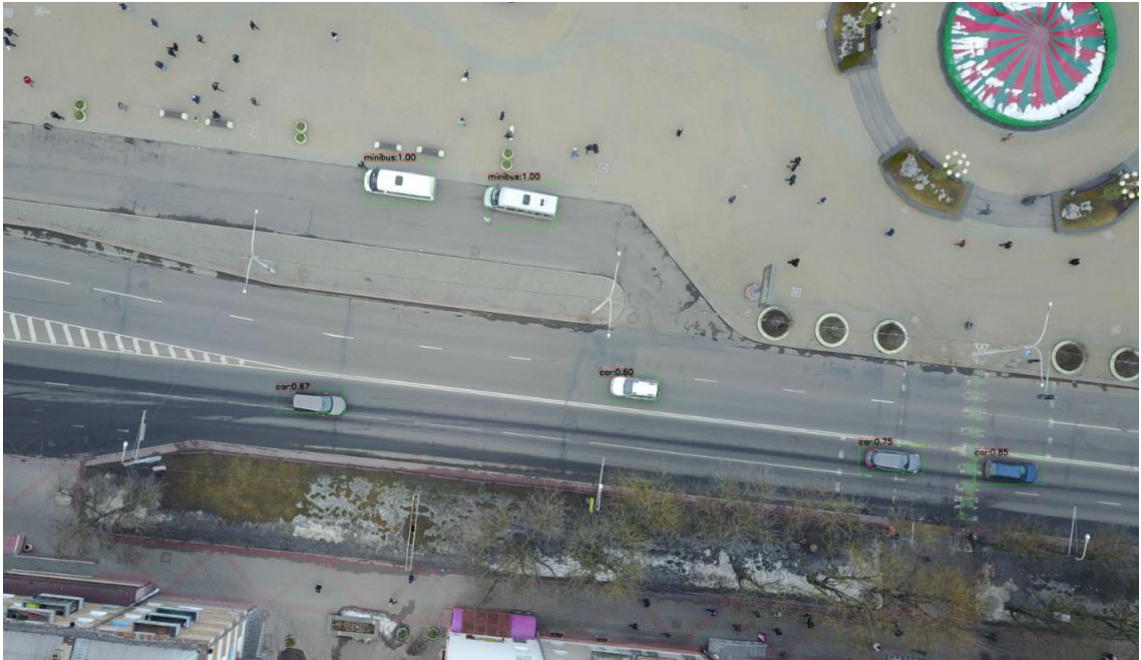
Şekil 4.6 100m üzeri (Yaklaşık 150m) yükseklikten çekilmiş drone görüntüsü üzerinden Faster R-CNN Beslemeli YOLO algoritmasının araç tespit başarısı
