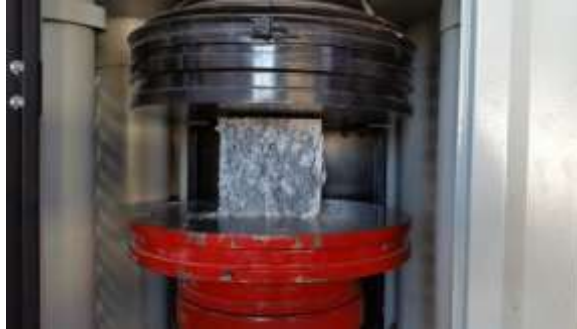
Şekil 1. Küp Basınç Dayanım Deneyi
