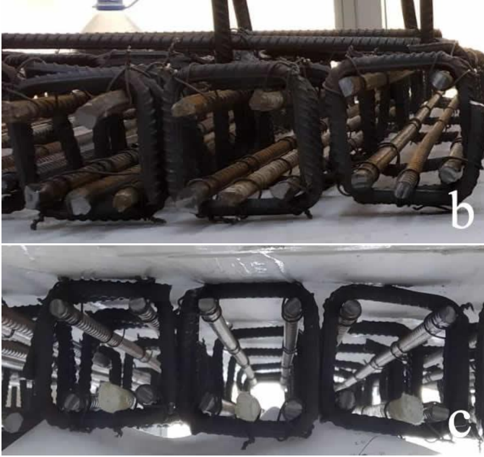
Şekil 1. Donatı detayı a) Cam FRP, b) Çelik c) Hibrit
