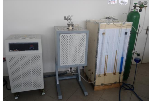
Şekil 2- İndirgeme deneyleri için kullanılan tüp fırın ve gaz besleme sistemi.
