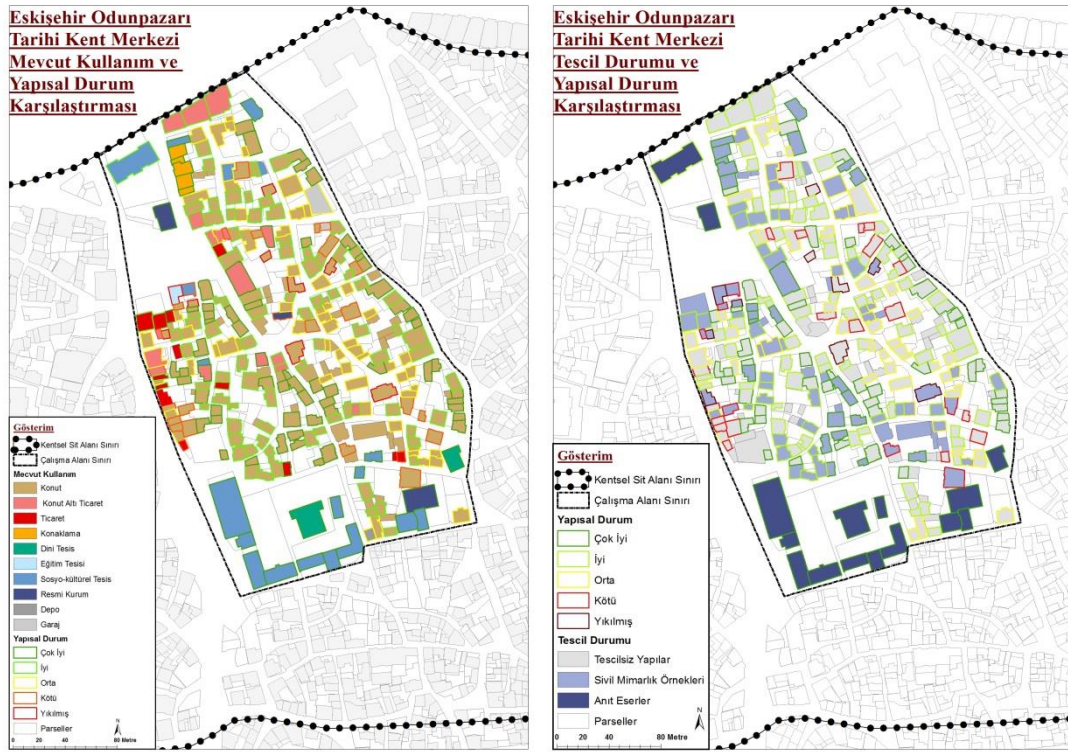
Şekil 9 Yapıların Fiziksel Durumlarının Tescil Durumu (a) ve Mevcut Kullanım (b) ile Karşılaştırılması
