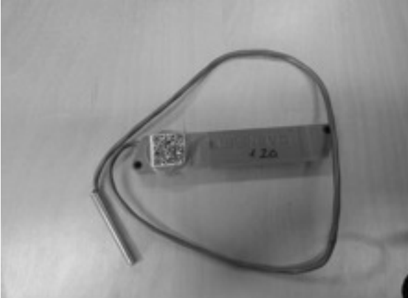
Şekil 3. RFID tabanlı sıcaklık sensörleri [35]
