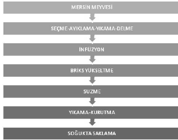
Şekil 1. Mersin şekerlemesi üretimi akış şeması
