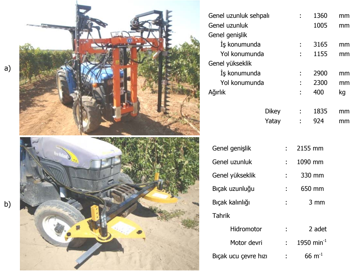
Şekil 1. Bağcılıkta yeşil budamada kullanılan makinaların genel özellikleri
