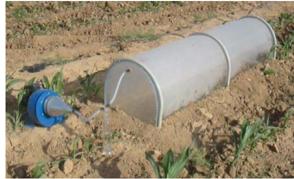
Şekil 3. Azot kaybı ölçme düzeni
