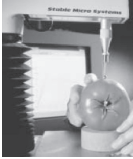
Şekil 2: Tekstür aleti farklı gıdaların tekstürünün ölçülmesinde kullanılır.
