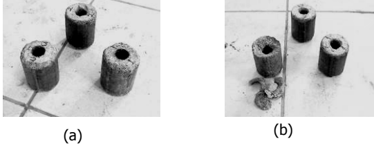
Şekil 12. Susam sapı briketi kırılma direnci test öncesi (a) ve sonrası (b) görünüşleri
