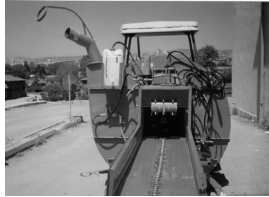
Şekil 5. Kombine makinanın görünüşü B: Balya iletici, Y: Yedirci, H ve M: Hidrolik motorlar, P: Pompa, T: NaOH deposu, A: Çıkış ağı
