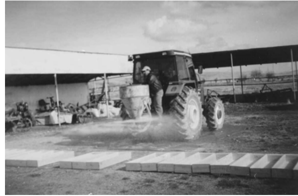
Şekil 4. Gübre dağılım deseninin saptanmasında kullanılan tahta kasaların dizilişi ve yapılan denemelerden bir görünüm.
