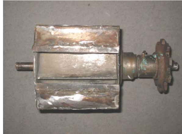
Şekil 3. Vericide kullanılan makaranın besleme kesit ağzının görünüşü
