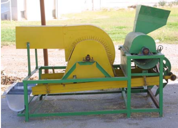
Şekil 2. Denemelerde kullanılan aksiyal akışlı harman makinasının genel görünüşü
