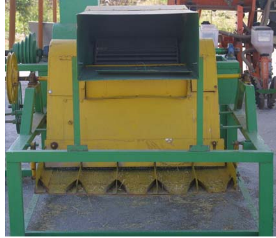
Şekil 4. Boşaltma ağızlarının genel görünüşü
