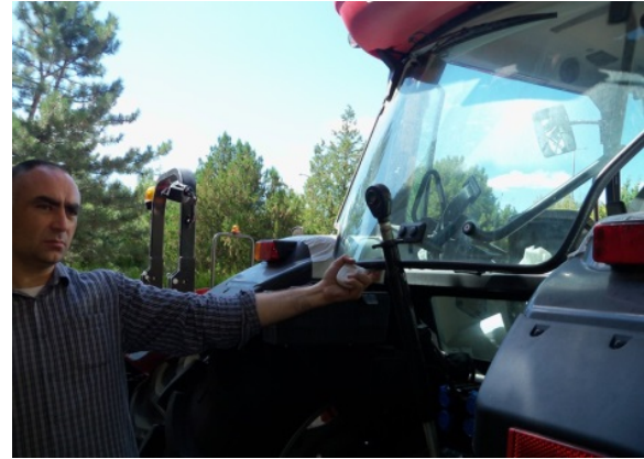
Şekil 16. Traktör 6, Uygun olmayan acil çıkış
