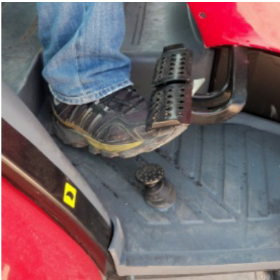
Şekil 15. Traktör 7, Uygun olmayan pedal yerleşimi
