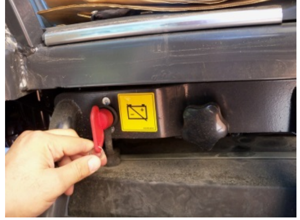
Şekil 19. Traktör 6, Standartta değinildiği şekilde bir devre kesici bulunan traktörler bu maddeye göre UYGUN olarak değerlendirilmiştir.
