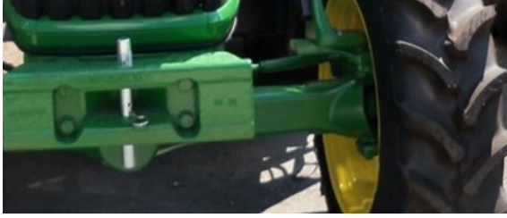
Şekil 17. Traktör 2, Kriko uygulama noktaları traktörler üzerinde işaretlenmemiştir. Bu durum UYGUNSUZLUK teşkil etmektedir.
