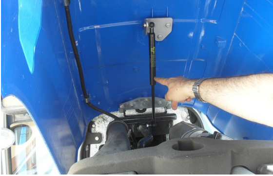
Şekil 14. Tarım traktörü 9, "Bakım İçin Destekler" yönünden UYGUNDUR.
