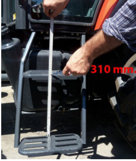
Şekil 7. Traktör 3, Uygun olmayan basamak
