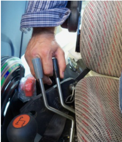
Şekil 4. Traktör 6, Uygun olmayan kumanda
