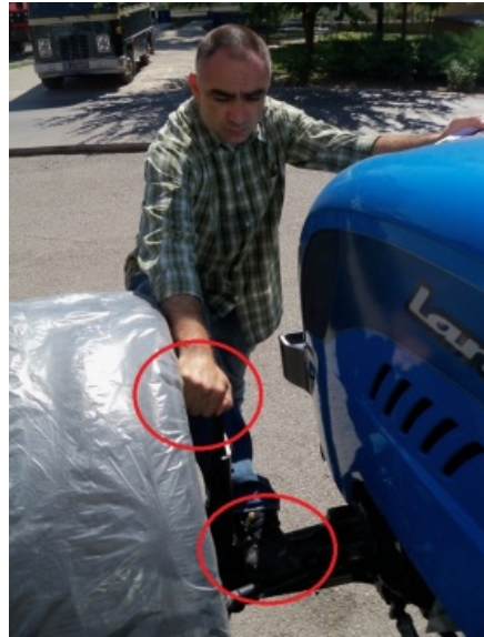
Şekil 13. Traktör 4, Traktörün ön tekerleğinde bulunan rot' a dikkatsizlik veya bilgisizlik sonucu temas/tırmanma/basma riski bulunmaktadır. Bu durum uygunsuzluk teşkil etmektedir.
