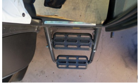
Şekil 9. Traktör 6, Şekil yönünden uygun basamak
