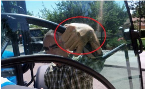
Şekil 8. Traktör 4, Uygun olmayan el tutamağı
