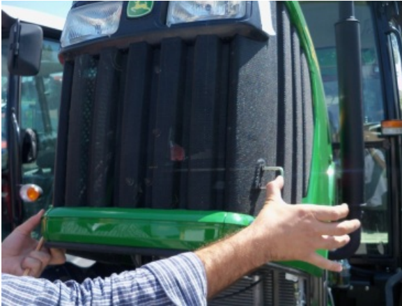
Şekil 11. Traktör 2, Riskli alana uygun olmayan erişim
