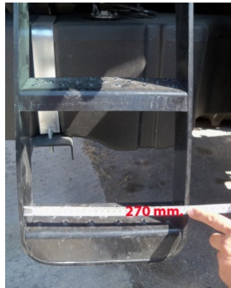
Şekil 6. Traktör 1, Uygun olmayan basamak
