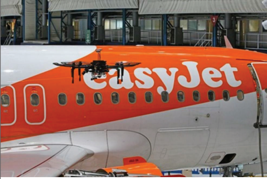
Şekil 1. Modifiye Edilmiş Bir DJI Matrice İHA ile EasyJet Airbus A319 İncelenirken [4]
