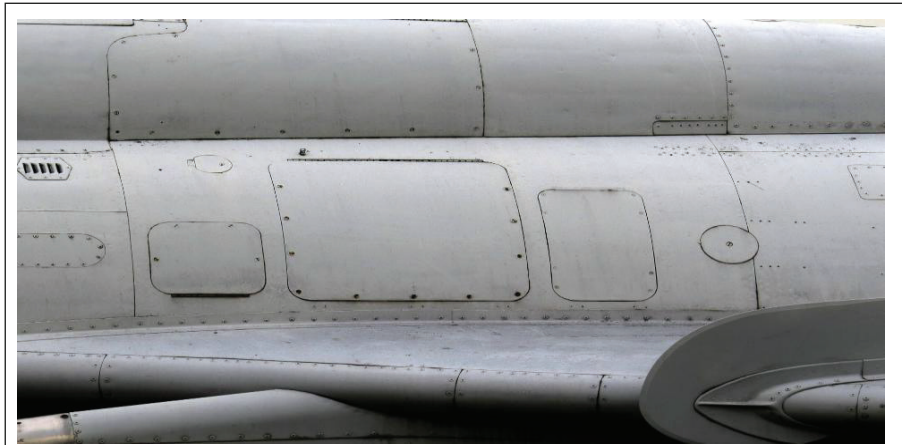
Şekil 5. Uçak Gövdesinde Perçinli Yapılara Örnek[11]
