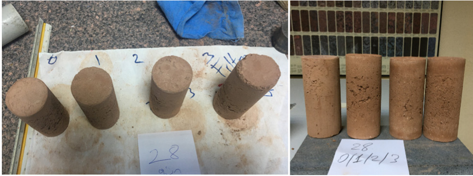
Şekil 11. 28 gün bekletilen ve Tek Eksenli Basınç Deneyi için yeterince sağlam olan numuneler
