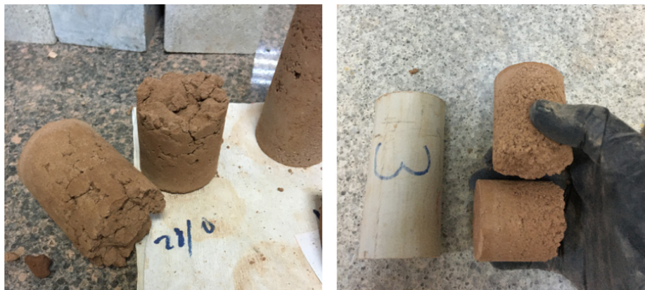
Şekil 7. Kalıptan çıkartma işlemi esnasında zarar görmüş numuneler
