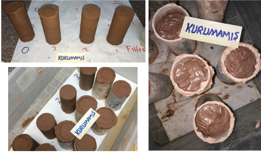
Şekil 8. 1 gün süre ile test için yeterli şekilde kurumayan bazı numuneler
