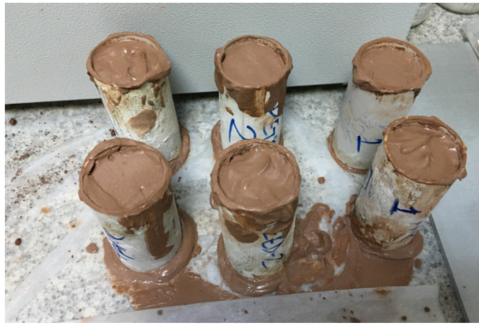
Şekil 3. Çamur halindeki malzemenin kalıplara doldurulması
