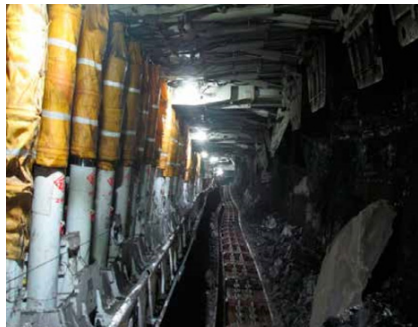
Şekil 2. Tam mekanize bir uzunayaktan görünüm (Özfirat vd., 2016)
