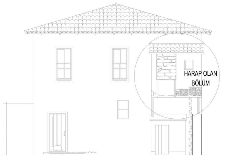
Şekil 3. 112 Ada 20 Parseldeki Evin Kuzey Cephesi (Kaynak: Bursa Kültür ve Tabiat Varlıklarını Koruma Kurulu)
