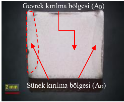
Şekil 9. Çentik darbe testi sonrası oluşan kırılma yüzeyi
