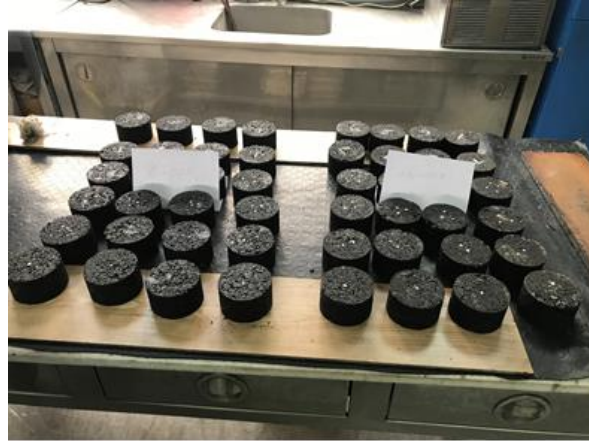
Şekil 2. Çelik fiber tel katkılı karışım numuneleri (Figure 2. Steel fiber-reinforced mix samples)
