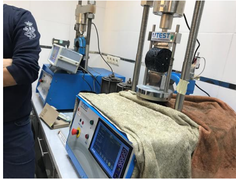
Şekil 3. Koşullandırılmış indirekt çekme mukavemeti deney numuneleri (Figure 3. Conditioned indirect tensile strength test specimens)
