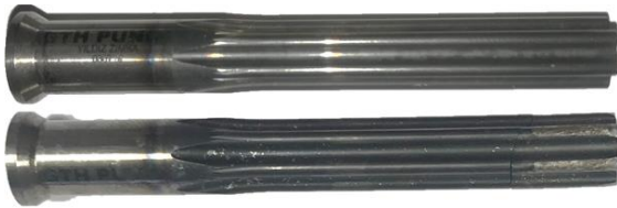
Şekil 6: AlTiN kaplı zımbanın ilk ve 514.500 delme işleminden sonraki hasar ile aşınma görüntüsü.
