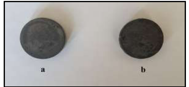
Şekil 1. Sinterlenen numunelere ait görüntü (a: Fe %90-Mg %10, b: Fe %95-Mg %5)
