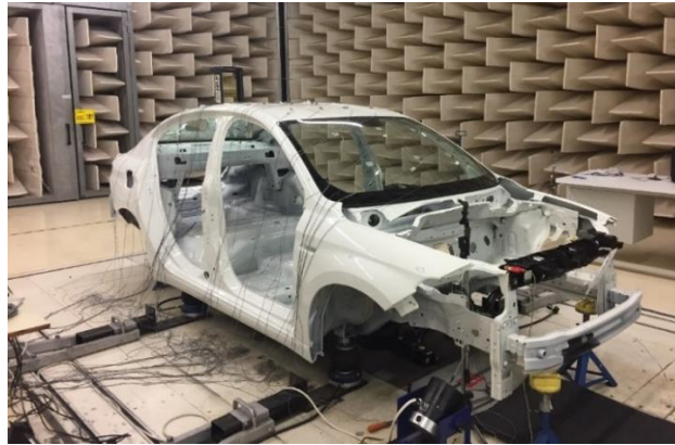
Şekil 1: Yankısız odada titreşim testi araç hazırlığı
