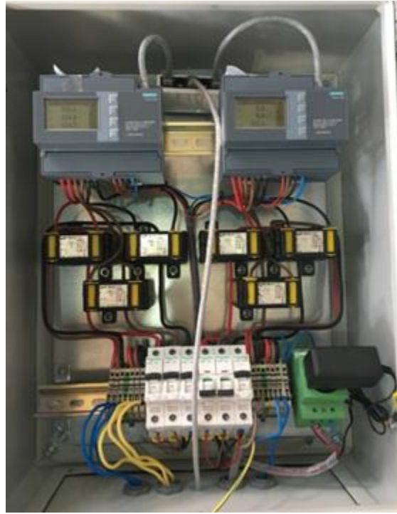
Şekil 2. Deneylerde kullanılan enerji ölçer sistemi görünümü (View of energy meter system used in experiments)
