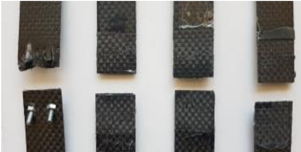
Şekil 4: Kopma bölgelerine ait makro resimler: a) vida ile birleştirilen, b) epoksi ile birleştirilen, c) karbon fiber tozu katkıli epoksi ile birleştirilen ve d) çift bileşenli yapıştırıcı ile birleştirilen numunelerin kopma bölgelerinin resimleri
