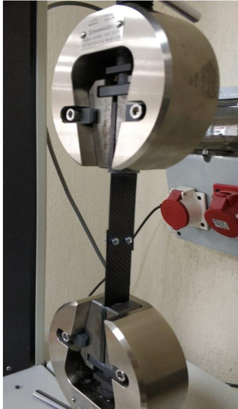
Şekil 2. Çekme testlerinin gerçekleştirildiği Shimadzu AG-IS 10 kN üniversal test cihazı
