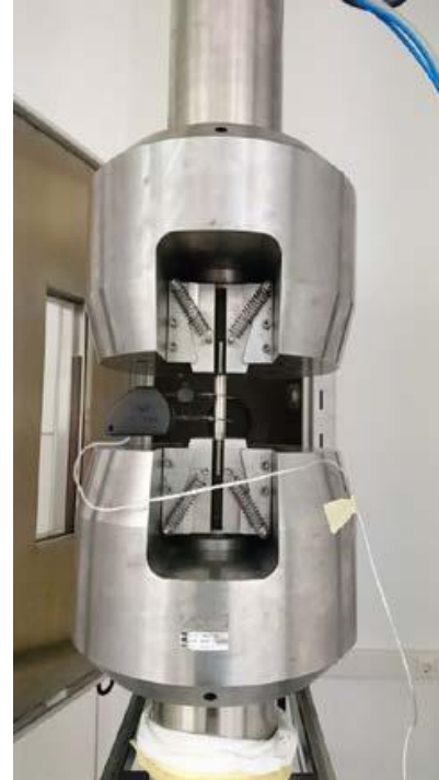
Şekil 4. Ekstensometreli Instron 8803 test cihazı Mikroyapı analizleri için numuneler dairesel kesitleri boyunca kesilmiştir. Sonra, Metkon Ecopress 50
