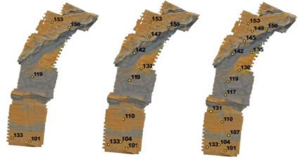
Şekil 7. Pix4D Mapper Pro ile değerlendirmede kullanılan 5-10 ve 15 YKN dağılım gösterimi
