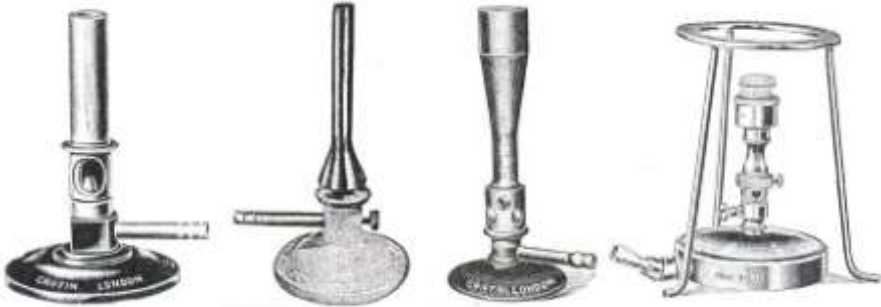
Şekil 22. Bunsen bekinden geliştirilen çeşitli beklar. Soldan sağa doğru Bunsen beki , hava ve gaz akımı çok daha duyarlı olarak ayarlanabilen Teclu beki , daha yüksek sıcaklıklar elde etmek için kullanılan ve ağzında metal bir kafes bulunan Méker beki ve Méker bekinin ağzında porselen levha bulunan türü.
