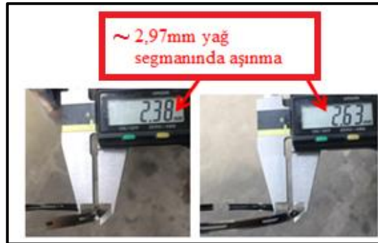
Şekil 1.2. Toz Partiküllerinin Emilimi Sonucunda Piston Segmanında Yaşanan Aşınma
