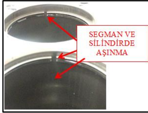
Şekil 1.3. Toz Partiküllerinin Emilimi Sonucunda Segman ve Gömlekte Yaşanan Aşınma
