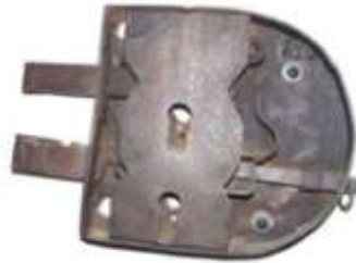
Resim 6. Anadolu kapı kilidinin i mekanizması.
