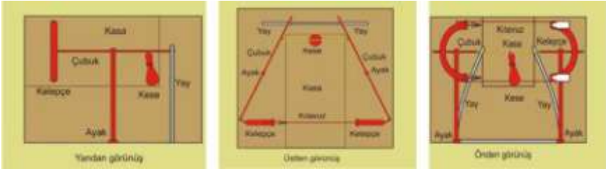
Resim 12. Takiyeddin bin Ma'ruf el-Râsîd'in 'utanç kilidi'nin çalışma mekanizması.
