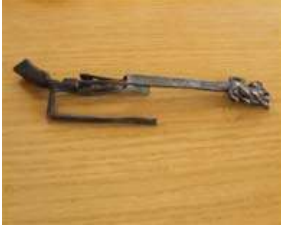
Resim 26. Yaylı asma kilit çubuk mekanizması.
