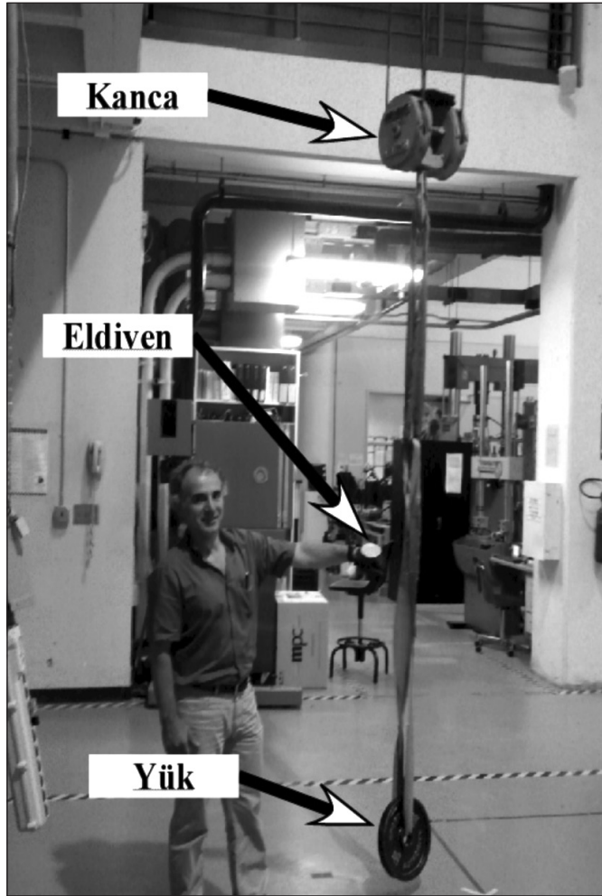
Şekil 4. Deneysel el hareketini takip eden vinç sistemi.
