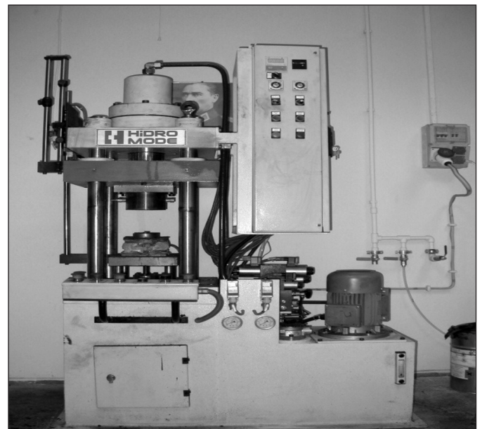
Şekil 8. SP tekniği ile üretilen numunenin kalıp ve pres sisteminin fotoğraf görüntüsü (Meydanoğlu 2006).
