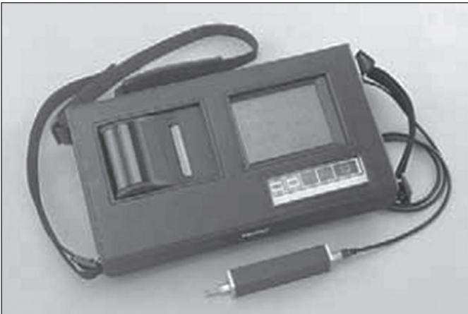
Şekil 3: Mitutoyo Surfes 301 yüzey pürüzlülüğü ölçme cihazı.
