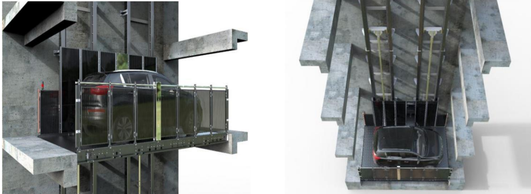
Şekil 1. Otopark katına erişim sağlayan hidrolik araç platformuna dair kesit ve yandan görünüş (Otomatik, 2019a).
