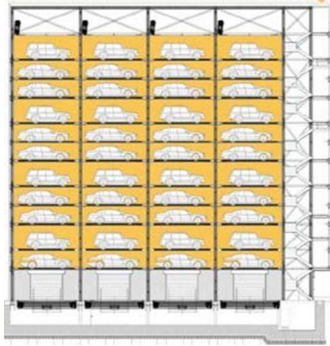
Şekil 10. Katların görüldüğü otopark kesiti (Otomatik, 2019e).
