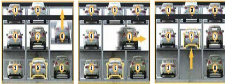
Şekil 5. Yarı otomatik otopark sistemi çalışma şeması (Otomatik, 2019d).
