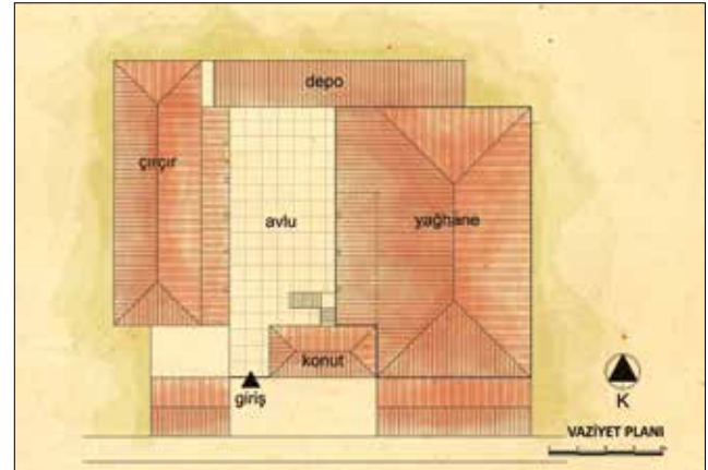
Şekil 10: Yeni Şakran'da bulunan zeytinyağı fabrikası vaziyet planı şeması (İzmir) / The site plan of Olive oil factory in Yeni Şakran
