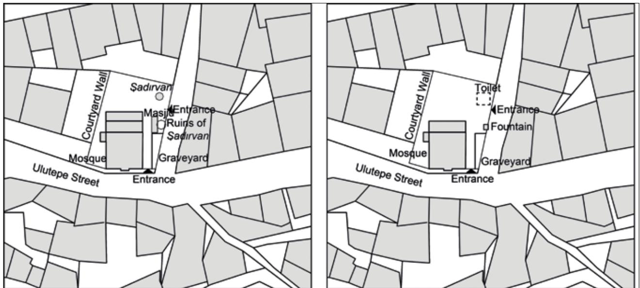
Figure 6 - Site plan drawings of Göktaşlı Mosque showing the states before (left) and after 2013 restoration (right) (Revised from RDPF). / Göktaşlı Cami'nin 2008 yılındaki (sol) ve 2013 restorasyonu sonrasındaki (sağ) durumunu gösteren vaziyet planı çizimleri (Vakıflar Bölge Müdürlüğü'nden yeniden düzenleme).
