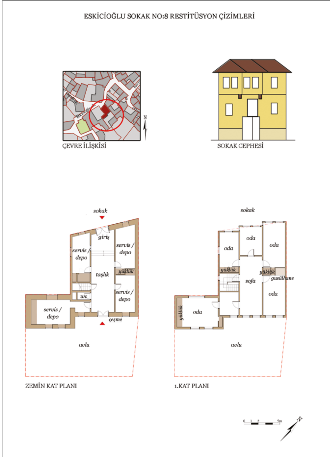
Levha 2 - Eskiçioğlu Sokak, No:8, şematik restitüsyon çizimleri: kat planları ve cephe / Eskiçioğlu Street, No:8, schematic restitution drawings: floor plans and facade
