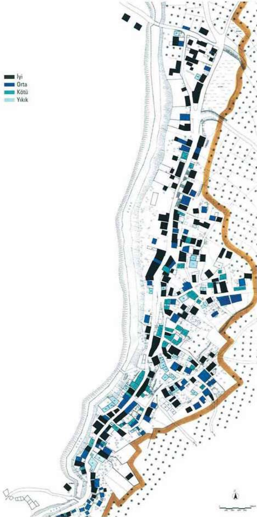
Şek. 11. Karsak köyündeki yapıların sağlamlık durumu analizi.
