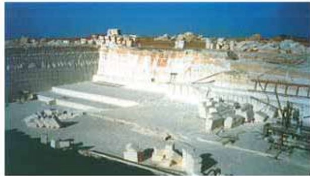
Res. 7. Birecik'te günümüzde sürdürülen restorasyon çalışmalarında (örneğin Mahmutpaşa Camii restorasyonunda) kullanılan Urfa Taşının çıkarıldığı ocak.
