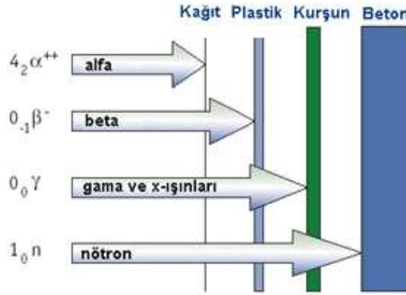
Şekil 2. Farklı radyasyon türlerine göre zırhlama malzemeleri [10]
