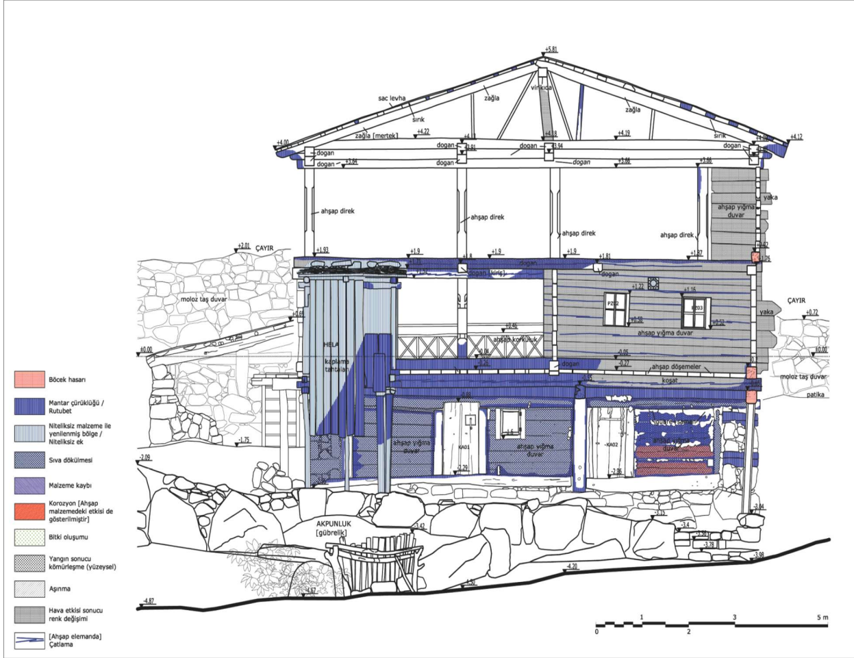
Res. 32b. Güneybatı cephesi hasar analizi
