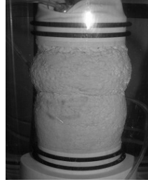
Şekil 3. Tek Sıra Donatılı Kum Zeminlerin Kırılma Şekli
