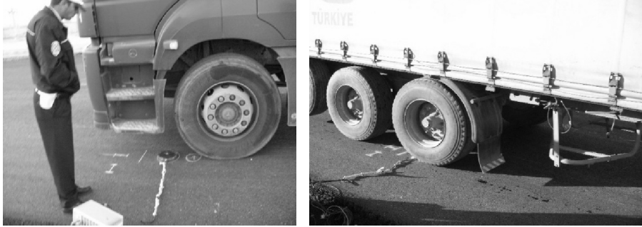
Şekil 6. Trabzon-Arsin karayolunda basınç ölçer ile gerilme ölçümü
