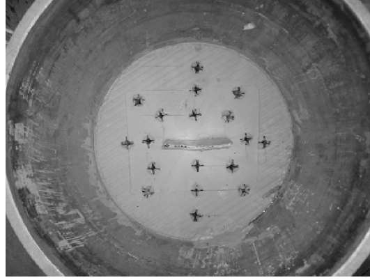
Şekil 6. PDD'den yatay ve düşey doğrultuda değişik uzaklıklarda drenajsız kayma dayanımının belirlendiği noktalar
